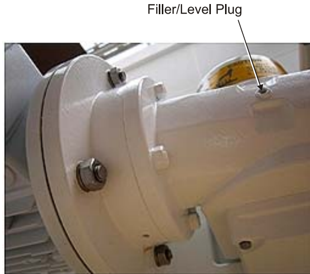
Figure 6.4 Rehfluss Gearbox - Filler/Level Plug
