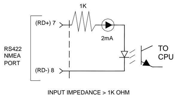
NO GROUND CONNECTION USED FOR RS422 INPUT.
